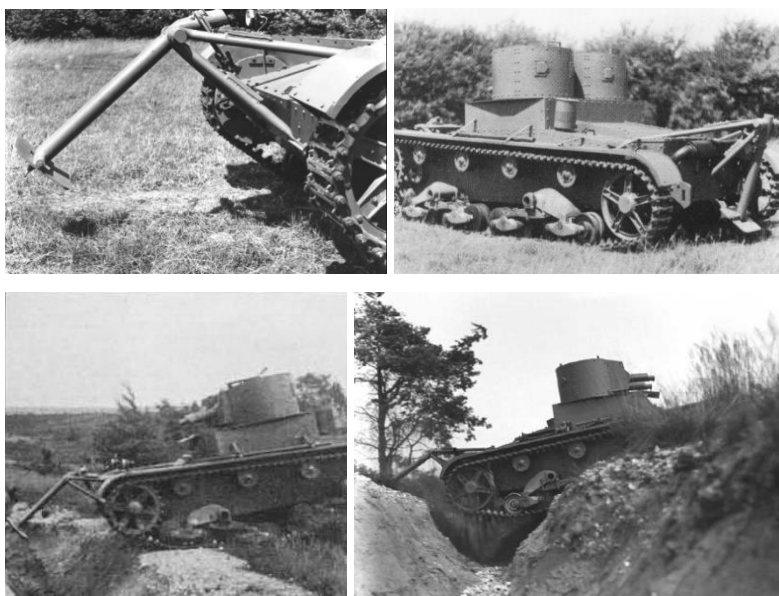
5. kép: Straussler-féle árokáthidaló egy Vickers 6-ton, másnéven Vickers Mk. E harckocsin. 96
