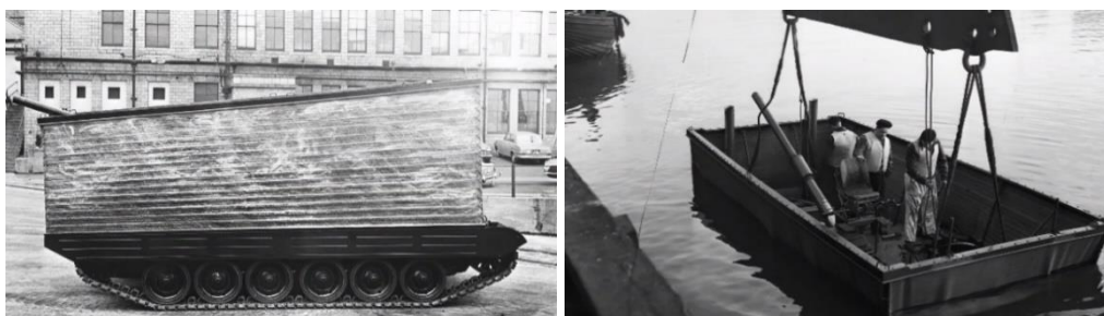
209. kép: A Straussler ötletén alapuló, de nem általa továbbfejlesztett, harmonikaszerűen illeszkedő ponyvaszerkezet egy brit, exportra szánt Vickers MBT Mk. 1 alapharckocsin. 1215
