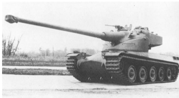
245. kép: A 120 mm-es, automata töltőrendszerű löveggel felfegyverzett francia AMX-50 nehéz harckocsi 1958-ban. 1466
