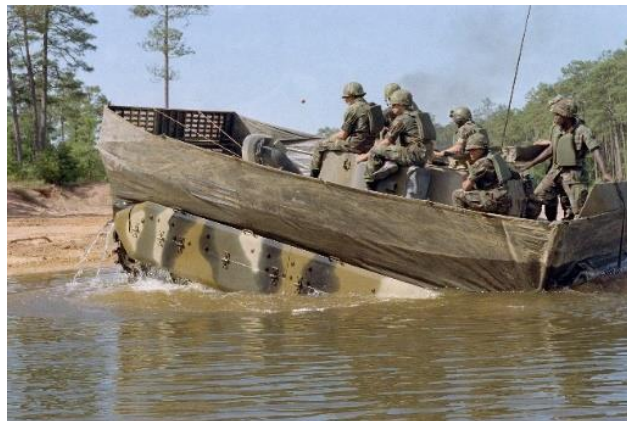
212. kép: Egy amerikai M2 Bradley lövészpáncélos úszóképességének demonstrációja közben, 1982-ben. 1224
