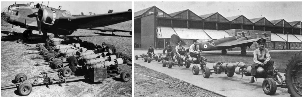
88. kép: Brit katonai reptereken rakodnak Type A és Type B bombatrélerek segítségével. 566
