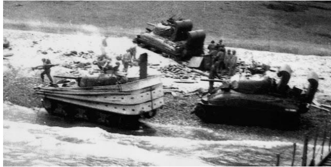
171. kép: Duplex Drive úszó- és Deep Wading Kittel szerelt mélygázló Sherman harckocsik az Omaha partszakaszon. 1035
