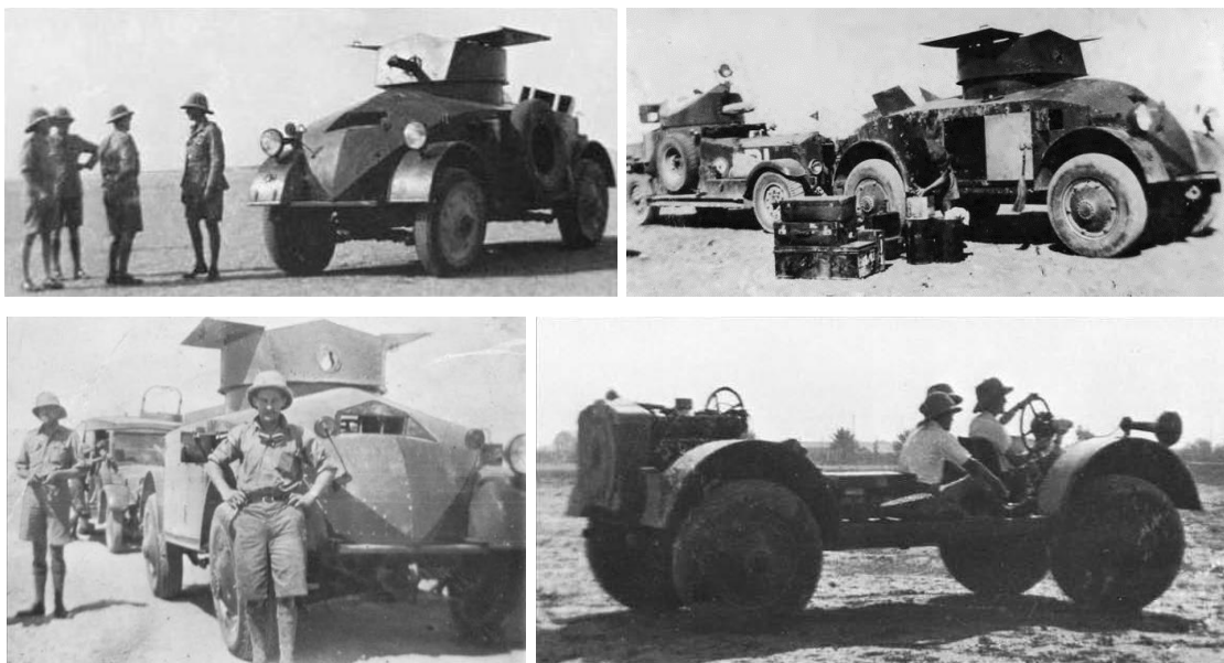
21. kép: Az AC-2 a sivatagi próbái során. A jobb felső képen az AC-2-es mögött egy olyan Rolls-Royce páncélauto is látható, amelyek leváltására hozták létre eredetileg Straussler páncélgépkocsijait. 218
