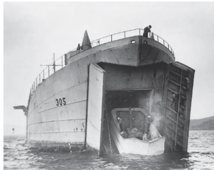
159. kép: Egy Valentine DD indítása egy LST(2) partraszálló hajóról. A magasabb Sherman DD már nem fért volna át a csapóajtón. 963
