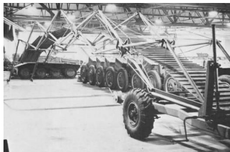
197. kép: Straussler ollós-szerkezetű hadihídjának szabadalmi rajza, és egy példánya a műhelyében. A háttérben a Tetrarch DD is látható. 1150
