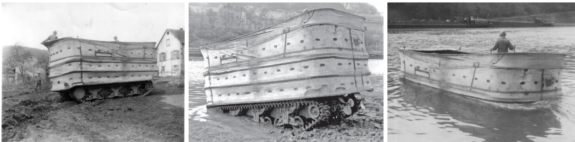
177. kép: Sherman DD gyakorlatozik valamivel később, 1945. áprilisában a Neckar folyón. Jól látszanak az úszóképeség újbóli eléréséhez szükséges toldások, javítások nyomai a ponyván. 1057
