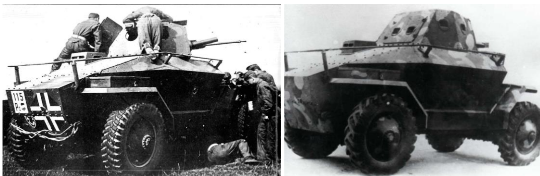
46. kép: A Cordatic régebbi (balra) és új, „sarkanyús” gumibroncsai (jobbra). 381
