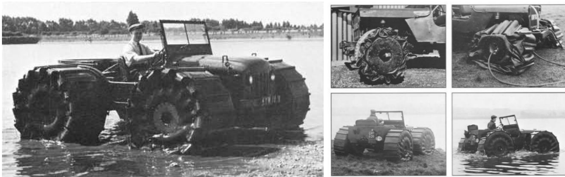
216. kép: A Floating Wheels úszóképességet biztosító kiegészítő abroncsok. 1252
