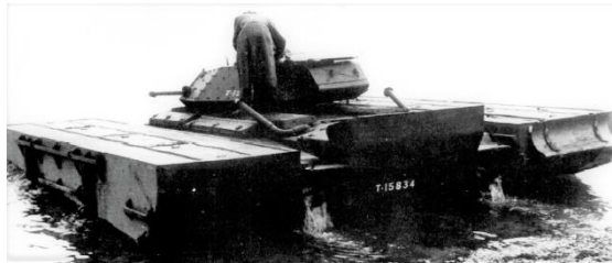
108. kép: Úszóképessé alakított Crusader. 667
