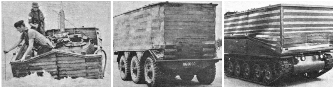
211. kép: Néhány példa a Straussler ötletének továbbgondolásával később úszóképessé alakított brit harcjárművek közül: az FV721 Fox kerekcsúszós páncélos felderítő jármű (balra), az FV601 Saladin páncélgépkocsi (középen) és az FV101 Scorpion lánctalpas páncélos felderítő jármű (jobbra). 1223
