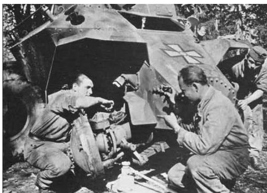
50. kép: Egy 39 M. Csaba futómű javítás közben. 400
