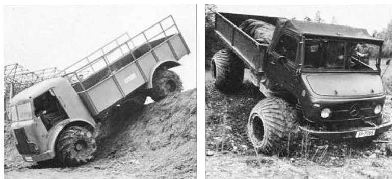
220. kép: Lypsoid kerekkel szerelt Barreiros és Mercedes-Benz teherautók. 1274
