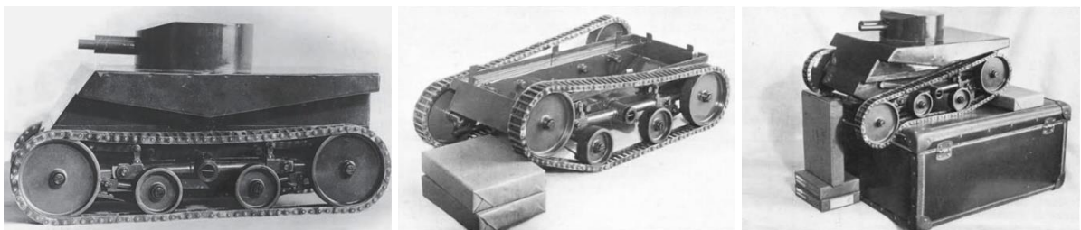
99. kép: Straussler saját tervezésű harckocsijának megépülte előtt, a tervező által 1934 körül készített, felfüggesztés működését szemléltető makett. 626
