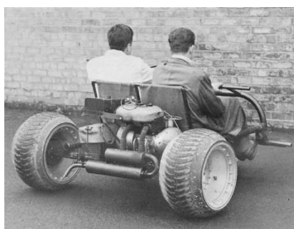
225. kép: A Straussler Collapsible Vehicle, a későbbi FN AS 24 előfutára.
