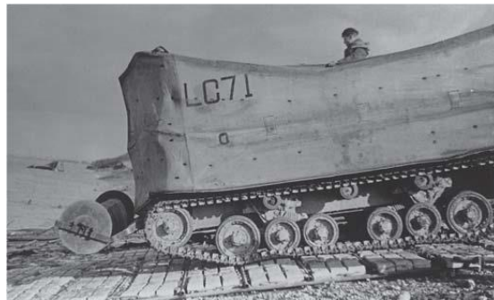
187. kép: A Holy Roller egy Valentine DD-re szerelve. 1090
