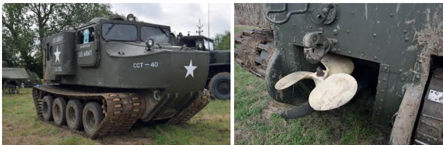
242. kép: Az M76 Otter katonai vontató, és annak Straussler által nehezményezett hajócsavar csatlakoztatási mechanizmusa. 1386
