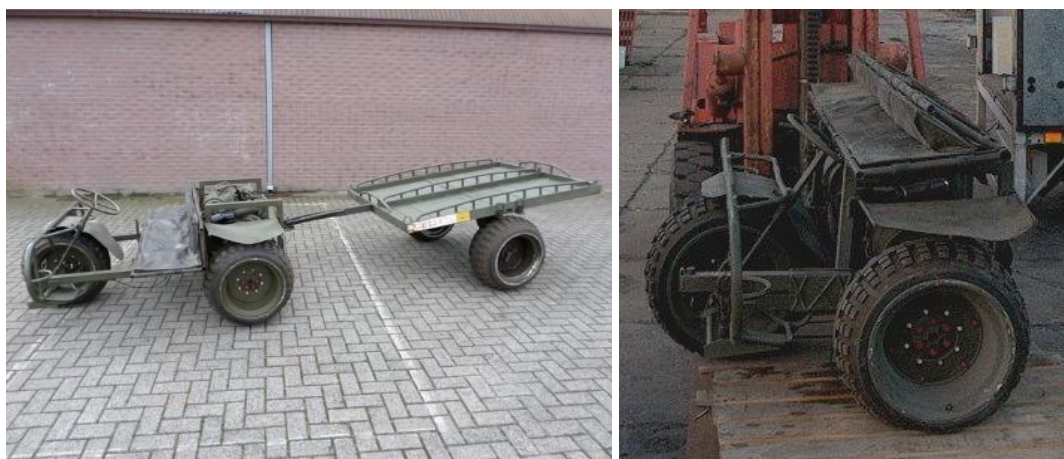
228. kép: Az FN AS 24 üzemkész állapotban a hozzá tervezett utánfutóval, illetve összecsucott, szállítási állapotban. 1319
