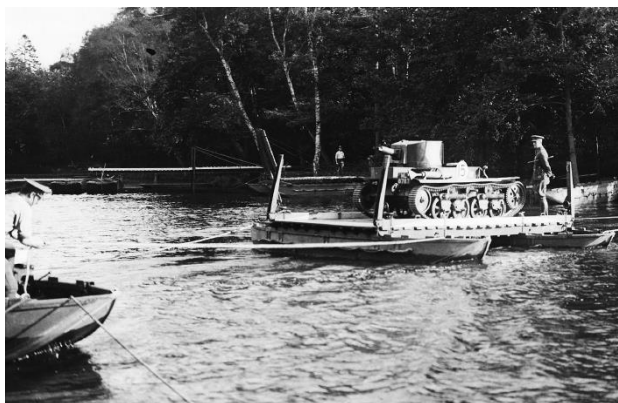
103. kép: Egy Vickers A4E5 könnyű harckocsi (a későbbi Light Tank Mark I egyik prototípusa) egy Straussler-féle, összecusukható pontonokon úszó uszályon kel át egy angliai folyón valamikor az 1930-as évek elején. 650
