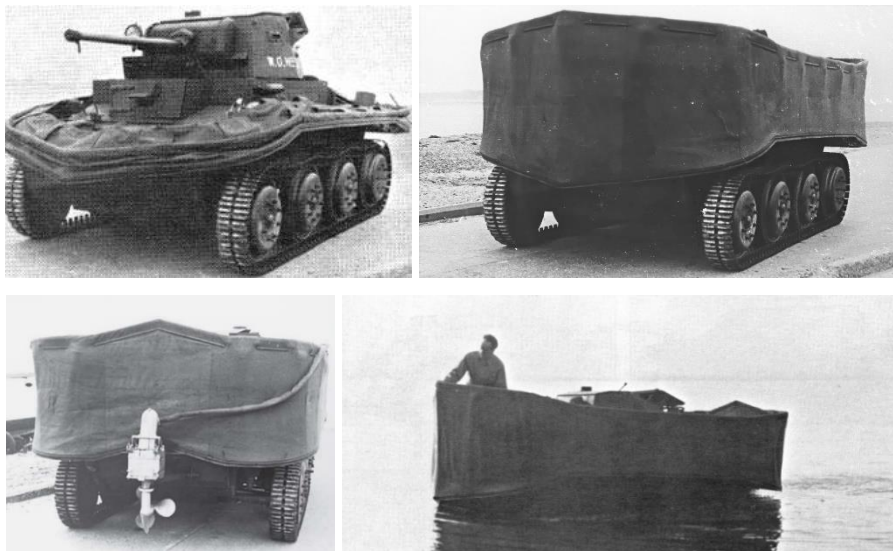
139. kép: A Tetrarch Duplex Drive úszóképes könnyű harckocsi. 867
