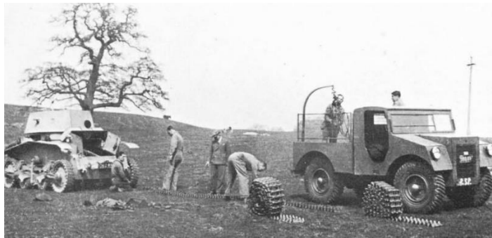
128. kép: A „Mark R” váltótalpas harckocsi a Coventry-től nem messze található Bagintonban megrendezett egyik bemutatója során kerékmenetről lánccmenetre vált. A kép jobb oldalán Nicholas Straussler egy másik konstrukciója, a Hefty vontató látható. 782
