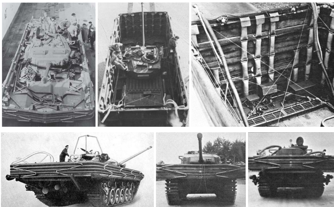
208. kép: Az FV4008 Centurion DD Straussler-féle ponyva- és meghajtási rendszerrel 1955 körül. 1213
