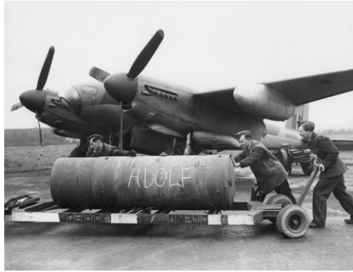
89. kép: Egy „HAPPY XMAS ADOLF” (Boldog karácsonyt Adolf) feliratú HC bombát egy Type D tréler segítségével rakodnak a világháború éveiben egy brit de Havilland Mosquito típusú repülőgépre. 569
