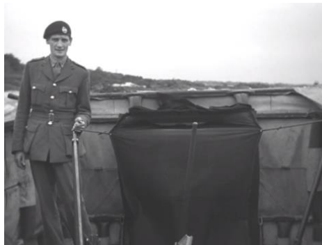
157. kép: A Sherman DD parancsnoka a torony tetjén kialakított platón állva irányozhatta az úszó harckocsit. Középen a kipufogógázok elvezetését elősegítő vászon légtelítő is látható. 958
