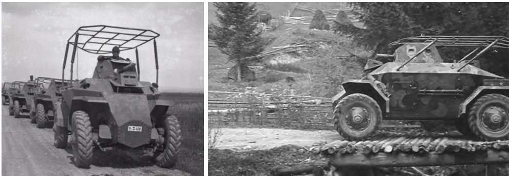
47. kép: A 40 M. Csaba jellegzetes rácsantennája felemelt, illetve szállítási pozíciókban.
